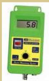
Les contrôleurs de pH proposés par les fabricants de matériel aquariophile, en plus de la mesure comme le type précédent, permettent l'alimentation ou la coupure d'une électrovanne, à des seuils que vous aurez définis. Il y a donc optimisation de l'injection du CO<sub>2</sub> par la surveillance permanente du pH.
